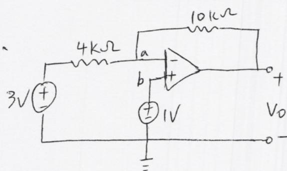
$$\frac{V_a - V_o}{10\text{k}\Omega} = \frac{3 - V_a}{4\text{k}\Omega}$$
